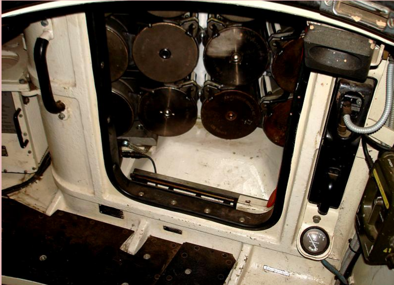
Der Platz des Ladeschützen bei geöffnetem Munitionspunker eines „Leoparden 2A4“, im Turmheck.
