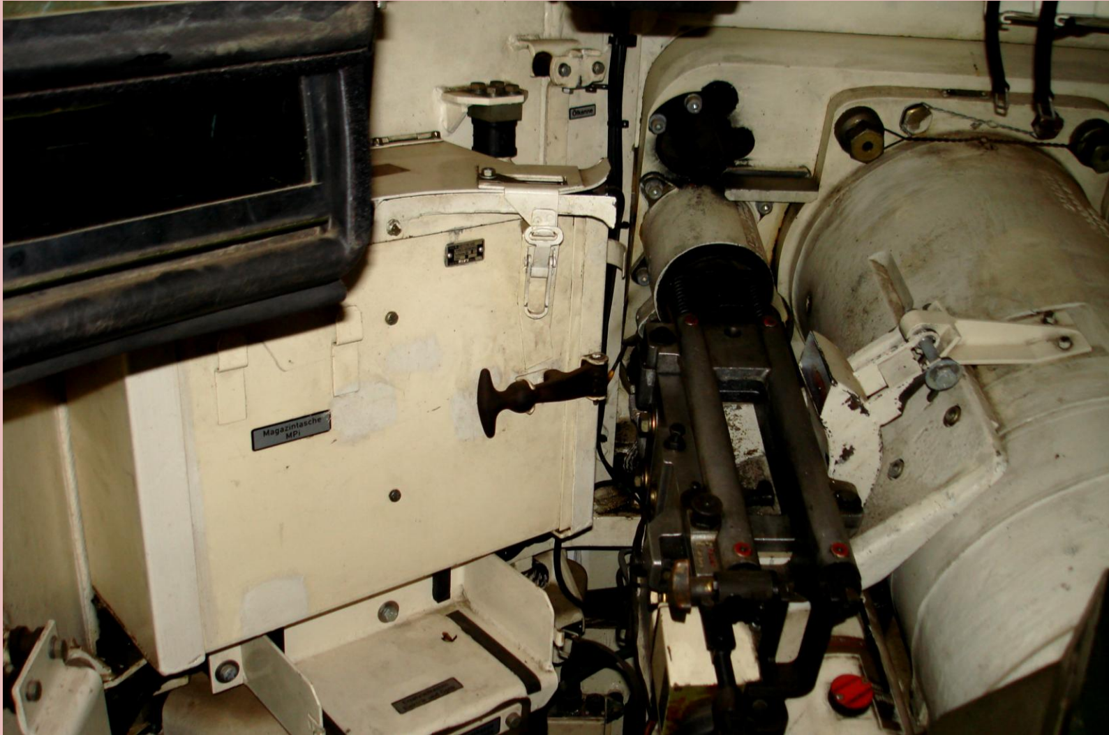
Ladeschützenplatz des „Leopard 2A4“ mit Lafette des Blenden-MGs, ganz rechts die Kanone, darunter die Rohrbremse (mit rotem Öldeckel).
